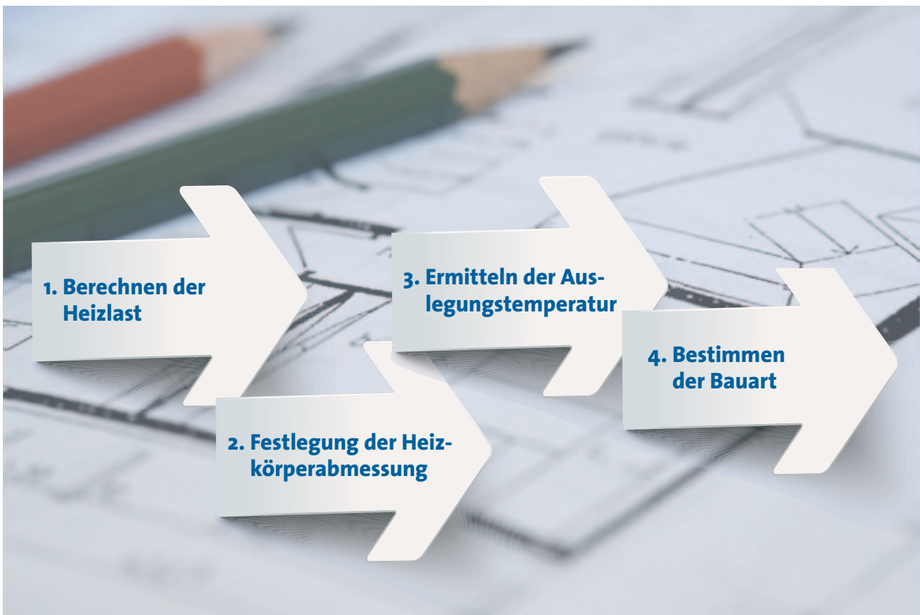
Bild 6: Planungsweg für die Auslegung von Heizkörpern
